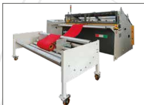
MOD 1 REW Equipaggiata di culla ed avvolgitore posteriore completo di albero ad espansione o aspo
